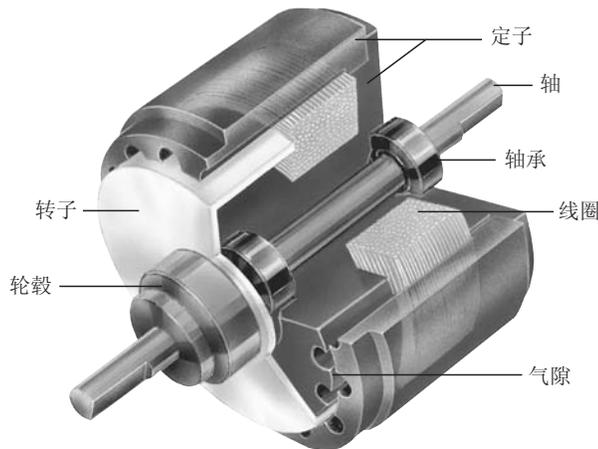
Magtrol磁滞式测功机通过导入电流至一个独特的磁滞刹车系统，产生无摩擦的扭力负载，不受转速限制。磁滞式刹车器主要由两个元件构成：一个网状磁极定子和一个特制钢做成的转子及转轴。这两个元件装配在一起但是并不互相接触。在给予定子激磁电流之前，转子和转轴都可以自由转动。当定子内线圈通电，定子磁极便产生磁性。相对应的气隙形成一个磁通区域互相吸引，转子受到定子的吸力。使得转子和定子之间产生一个磁滞效果。
